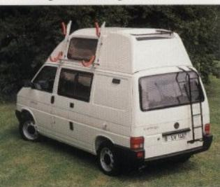
Gepäckgalerie, Leiter an Heckklappe, Surfständer für Hochdach
