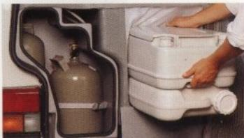
Toilette von außen entnehmbar, Gasflaschen-sicherheitsbehälter
