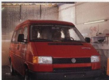
Dichtheittest in der Beregnungsanlage
