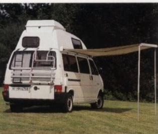
Dach-Gepäckbox, Leiter an Heckflügeltüre, Heckträger für Heckflügeltüre, Markise
